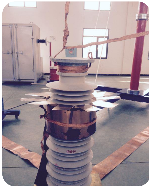
Steep-front Impulse Voltage Test 陡波试验
